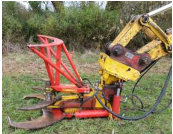
Abbildung 11: Kneifkopf für die Heckenpflege Foto: O. Anderßon
